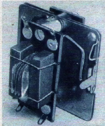
So ist die selbstgewickelte Eifenkern-Spule mit dem Drehkondensator zusammengebaut.
